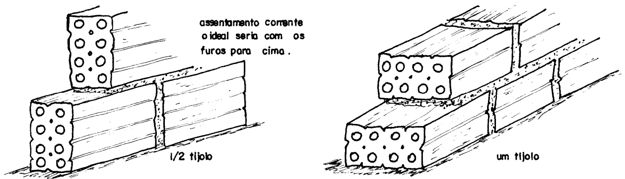
Figura 1 - Execução de alvenaria utilizando tijolos furados.
