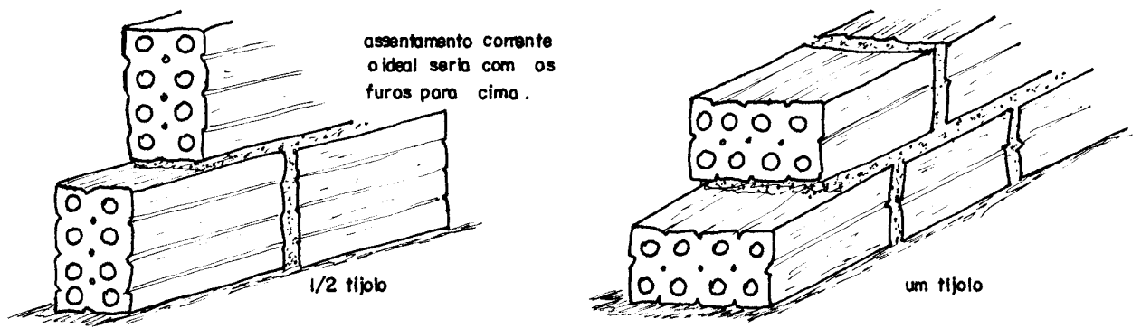
Figura 1 - Execução de alvenaria utilizando tijolos furados.
